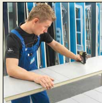
Hier wird die Schichtdicke der beschichteten Oberfläche gemessen.
