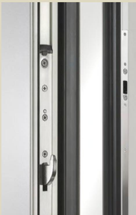
*Die Basisausstattung jeder Graute Haustür beinhaltet das 3-Punkt-Schwenriegelschloss mit durchgehender Schließleiste in Edelstahl. Zwei stabile Stahl-Schwenriegel und ein mittig angeordneter rechteckiger Riegel greifen tief in die Schließteile ein und gewährleisten einen optimalen Anzug und hohe Sicherheit.*
